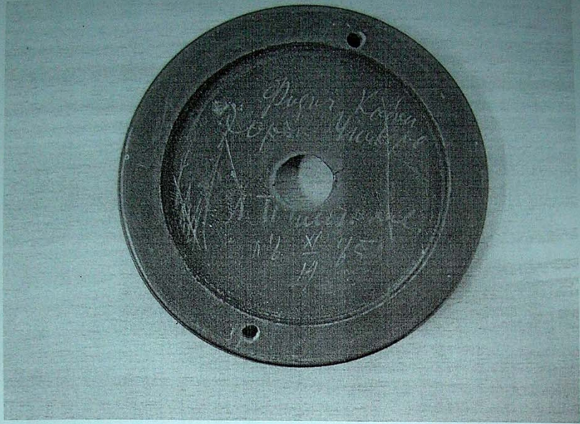
Ртутний еталонний резистор, який був придбаний М.Д. Пильчиковим для фізичного кабінету університету, про що засвідчено його автографом на кришці приладу
